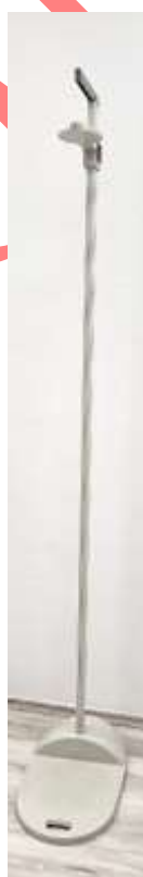
Slika 5 Prijenosni antropometar Seca 213 korišten u istraživanju u svrhu mjerenja tjelesne visine ispitanika
