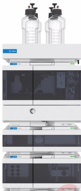
Slika 18 HPLC sustav za analizu pojedinih polifenolnih spojeva
