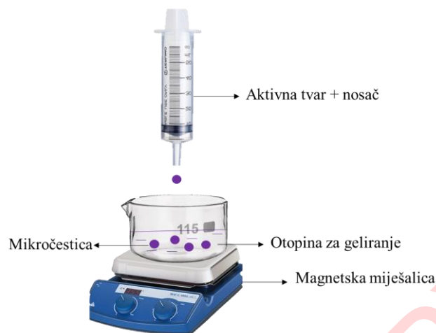
Slika 7 Priprema mikročestica pomoću ionskog geliranja (Patil i sur., 2012)
