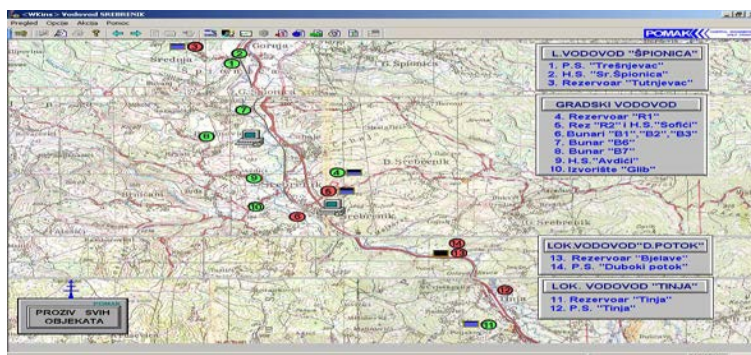
Slika 2. Telemetrijski sustav vodoopskrbnog sustava Srebrenik
