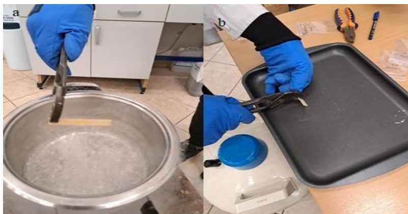
Slika 39 Tijek pripreme uzoraka za snimanje SEM-om; a) smrzavanje materijala tekućim dušikom, b) kidanje materijala kliještima
