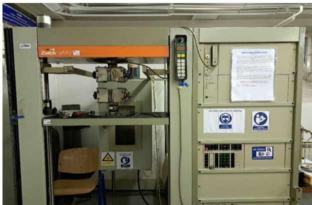
Slika 43 Univerzalna mehanička kidalica Zwick 1445
