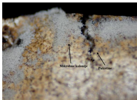
Slika 116 Površinska mikrostruktura uzorka TPS_SL 13-25_5 % LK/PLA 60/40 nakon 56 dana procesa biorazgradnje
