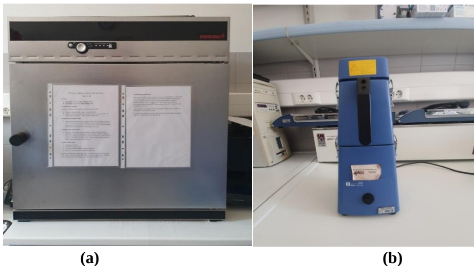
Slika 28 Laboratorijsku sušionik Memmert UFE 500 (a) i mlin IKA M20 (b)
