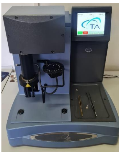
Slika 42 Termogravimetar Q500 (TA Instruments)
