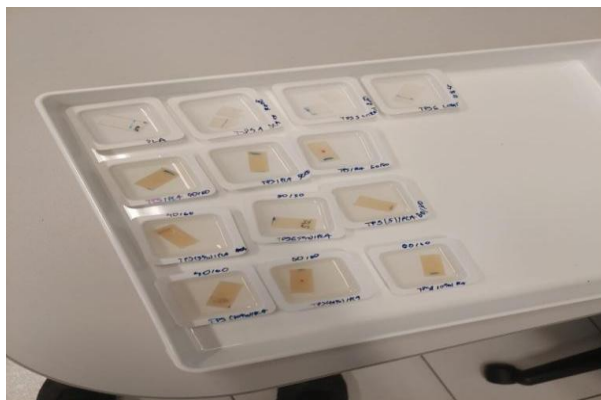
Slika 46 Ispitivani uzorci pripremljeni za test apsorpcije vode
