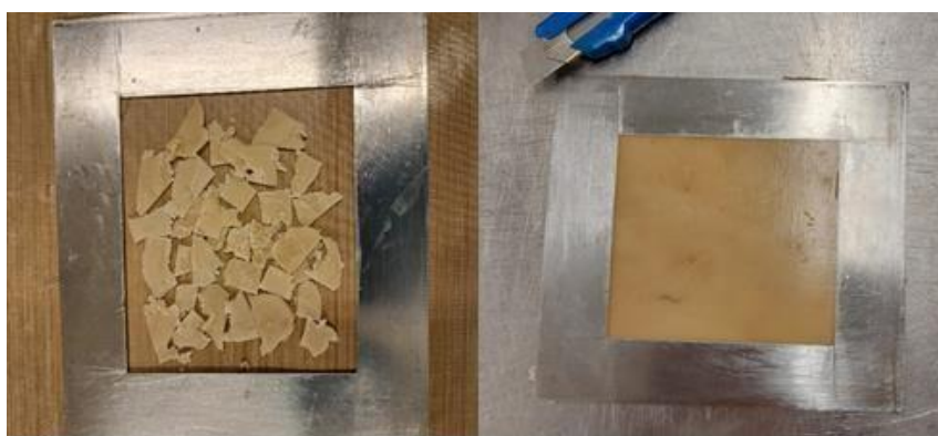
Slika 37 Materijal u kalupu; prije (lijevo) i nakon prešanja (desno)
